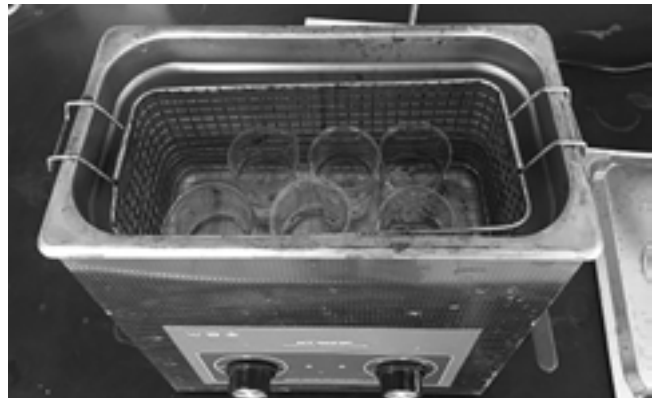
▲ Hình 2. Tẩy trắng thạch anh bằng thiết bị rung siêu âm
